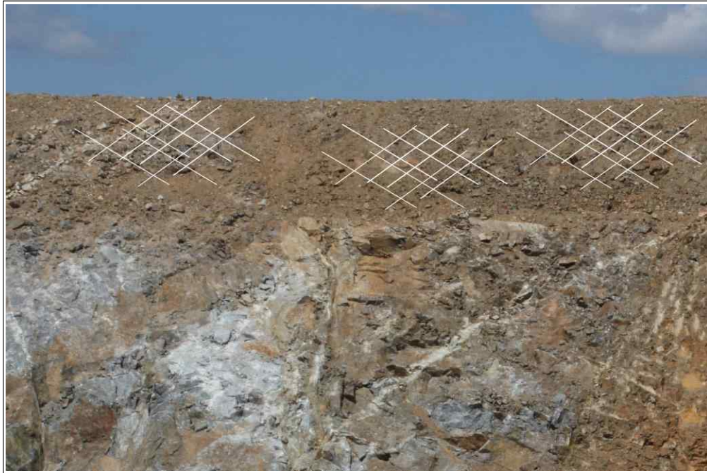
【그림 15】 B 영역 상세사진 (세편화된 암석)
